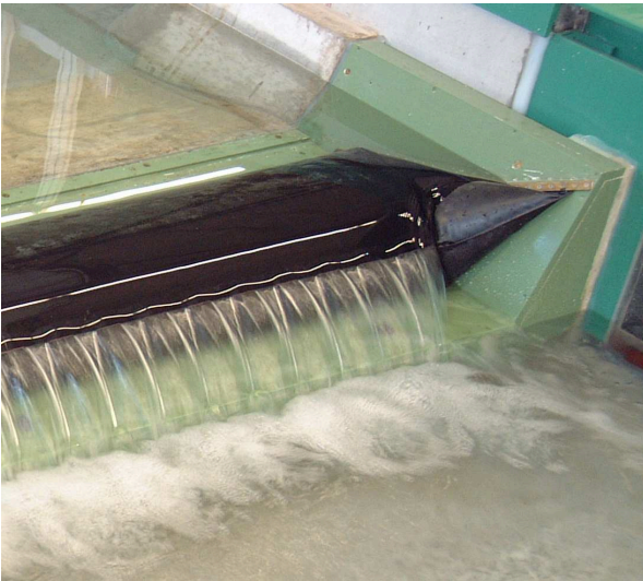
a. Wassergefülltes Modell mit Deflektor
