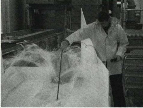
Abbildung 3 Messungen am Tosbecken der BA (Kegelauslassventil ohne Strahlführungsrohre)
