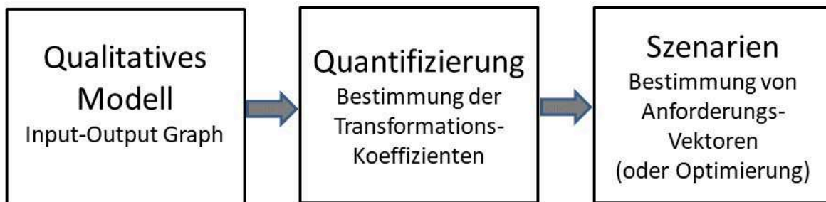
Abbildung 5.1: Ablauf einer Input-Output-Modellierung für ein wasserwirtschaftliches Problem
