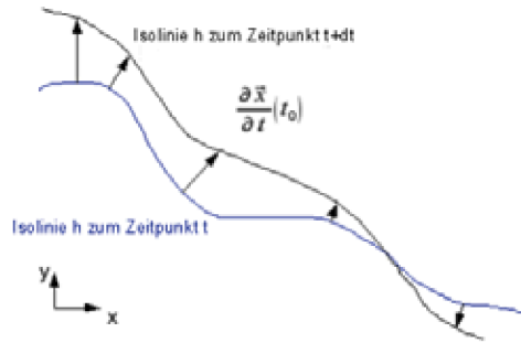
Abb. 22: Isolinienbasierte Bestimmung der morphologischen Geschwindigkeiten
