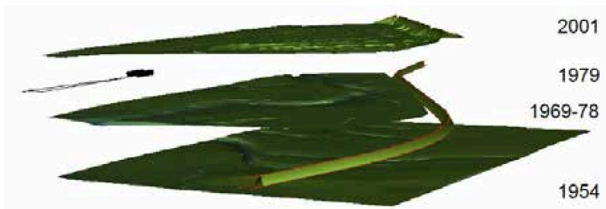
Abb. 3: Digitale Vermessungen mit Ersatzmodell der Eindeichung der Meldorfer Bucht
