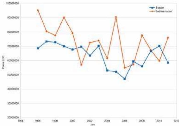
Abb. 18: Flächen, die von Erosion bzw. Sedimentation betroffen sind (Schwellwert 0,5 m)
