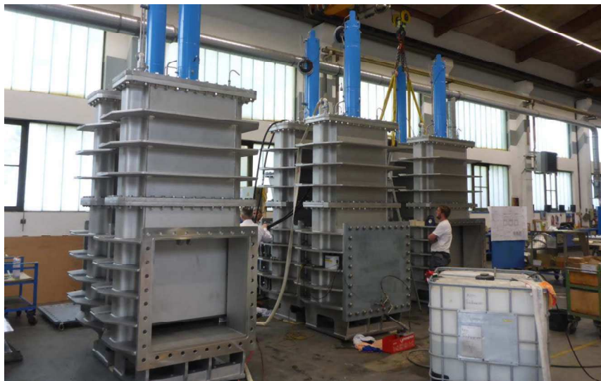
Abbildung 2: TSS während der Druckprüfung beim Hersteller (Quelle: LHP 2018)
