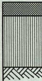
12 cm Bild 3: Beispiel für eine Parkplatzbefestigung mit Dränasphalt
