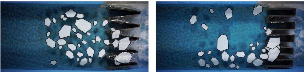
Bild 5: Versuchsablauf zur Untersuchung der Treibeisdurchgängigkeit an gefalteten Wehren.
