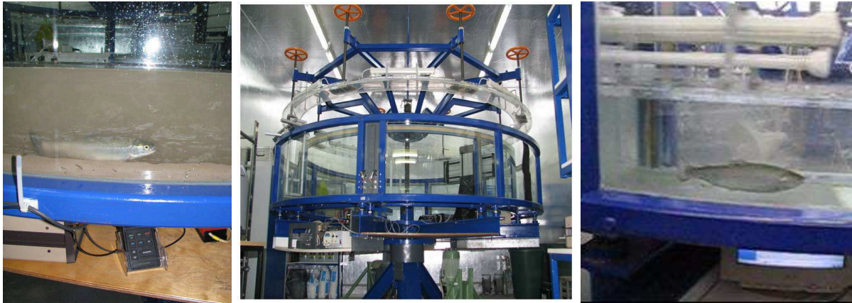
Abbildung 2: Ökotoxikologische Untersuchungen im Kreisgerinne des IWW mit Sedimenten (links); Kreisgerinne (Mitte); Vergleichsuntersuchungen ohne Sedimente (rechts)
