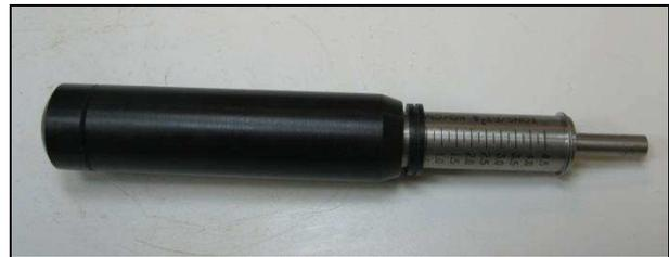
**Bild 10:** Taschenpenetrometer mit Skalierung
