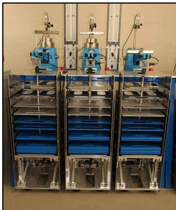
**Bild 25:** automatisierter KD-Stand des bodenmechanischen Labors der BAW-Hamburg
