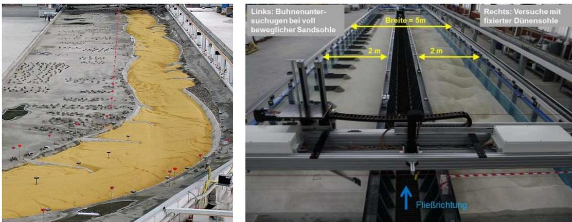
*Bild 1: links: Flächenmodell der Oder bei Hohenwutzen (Länge 78 m), rechts: Laborrinne für morphologische Untersuchungen (Länge 30 m)*
