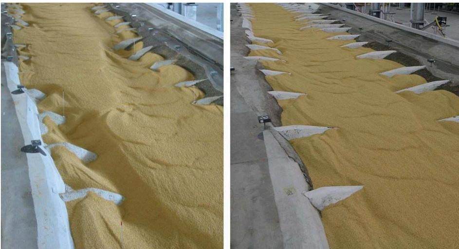
*Bild 2: Flächenmodell der Oder bei Hohenwutzen, Auswirkung von Bühnenformen auf die Kolkform bei einem Sandfluss ( $d_m = 1 \text{ mm}$ ) links: steile Bühnen im Ist-Zustand, rechts: flache Bühnen einer Bauwerksvariante*
