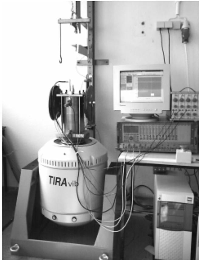
Bild 3: Schwingungsprüfstand mit dynamischem Ödometer zur Untersuchung des Setzungsverhaltens von Bodenproben bei Schwingungsbeanspruchung
