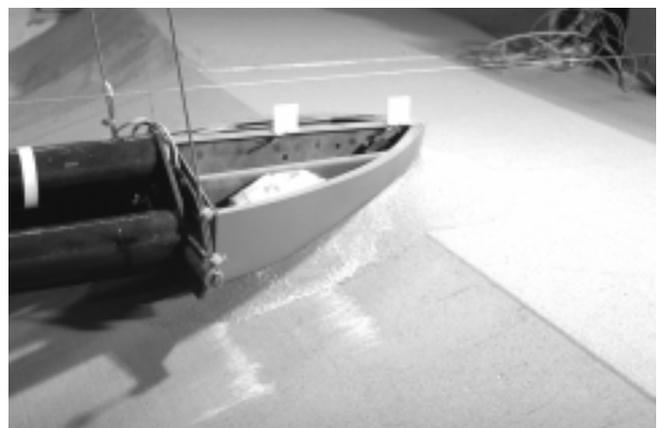
Bild 4: Modellversuch (Maßstab 1 : 23) zum Schiffsaufprall auf eine Erdböschung
