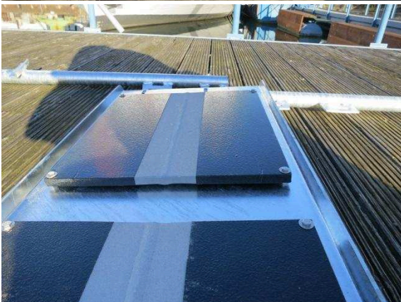
Bilder 3 bis 6: Prüfbleche für Binnenauslagerung auf Befestigungskonstruktion montiert
