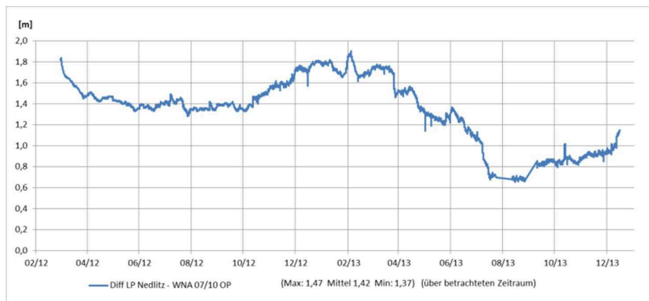
Bild 2: Differenz zwischen Oberflächenwasserstand und Grundwasserstand an Messstelle WNA07/10OP
