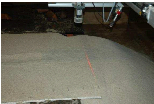
Bild 1: Aufmessen des Sohlprofils mit dem Laserscanner, Geisenhainer, P., Koll, K. (2014)
