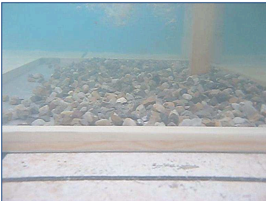
Bild 1: Schlagende Flosse über einer Lockersedimentsohle, die im Modellmaßstab einer Sohl-sicherung aus LMB 5/40 entspricht.
