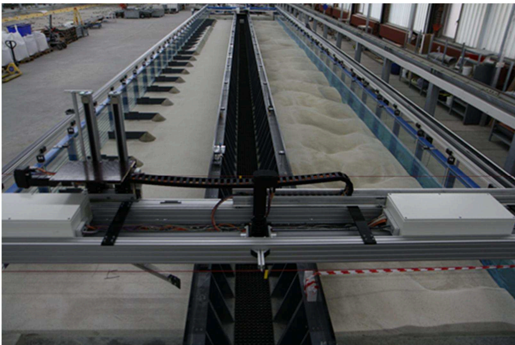
Bild 1: Untersuchung an der flussbaulichen Systemrinne mit beweglicher Sohle, links Untersuchungen an umströmten schematisierten Bühnen und Deckwerken, rechts Untersuchungen an einer fixierten Dünensohle
