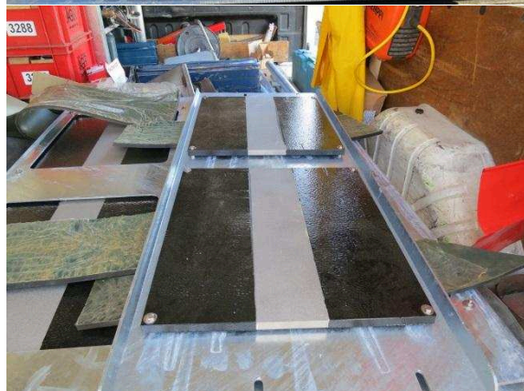
Bilder 3 bis 6: Prüfbleche für Binnenauslagerung auf Befestigungskonstruktion montiert
