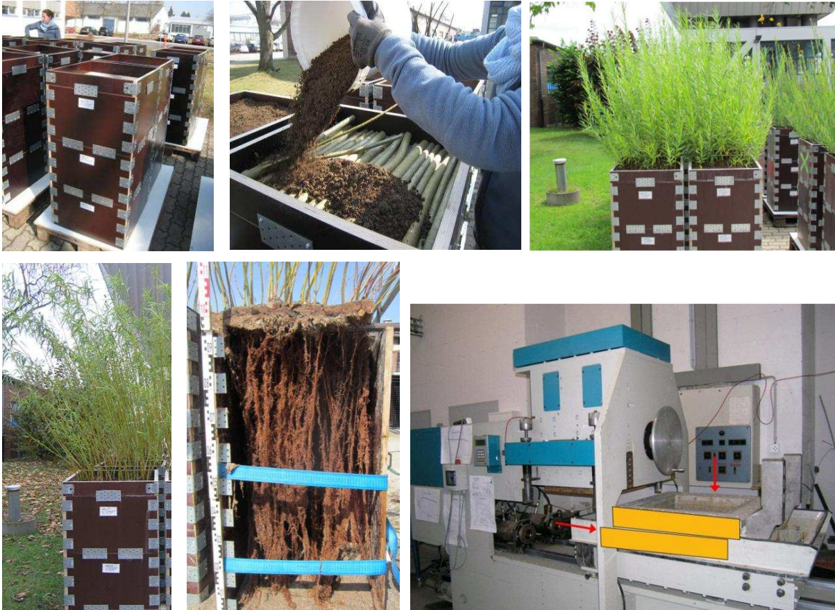
Bild 2: Versuchskästen zur Anzucht von Weidenspreitlagen für Scherversuche und Großschergerät
