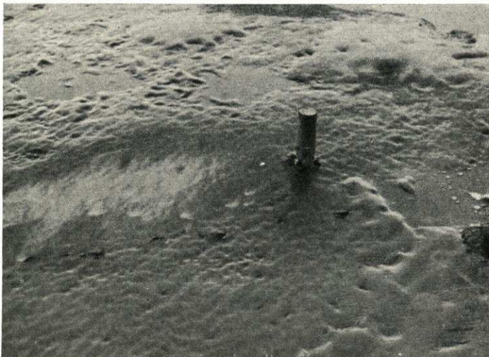
Abb. 29 Rotsandstation auf einer Schlicktafel zwecks Messung der biogenen Sedi- mentation. Links vom Stationsholz ist der soeben als Indikator ausgestreute rote Sand noch erkennbar (vgl. Text S. 62)
