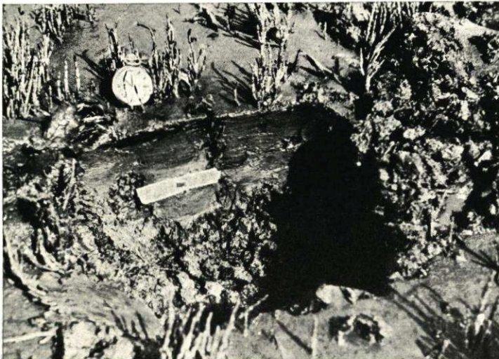
Abb. 62 Aufschlickung eines Winters. Aufgrabung in der Rotsand- station Nr. 32 vom Profil IV (vgl. schemat. Abb. 59). In 60 mm Tiefe liegt der rote Sand (siehe weiße Papiermarke; Uhr als Maßstab)
