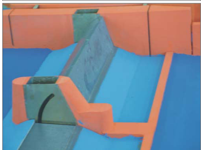
Bild 22: Wehranlage Grevenmacher – Werkstattzeichnung und eingebauter Modellwehrgörper
