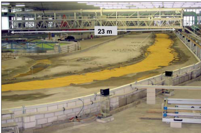
Bild 22: Übersicht Oder-Modell Hohenwutzen mit Messbrücke im Hintergrund
