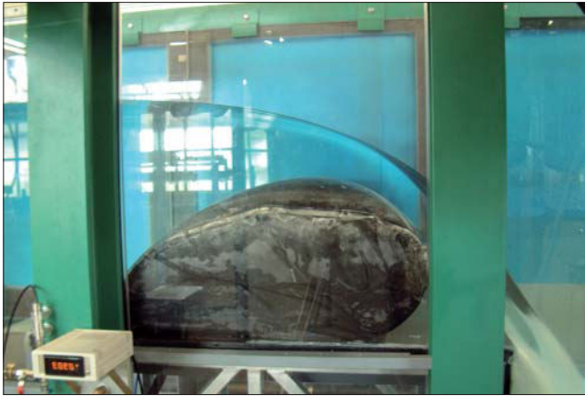
Bild 14: Überströmtes Schlauchwehr in der 0,80-m-Rinne
