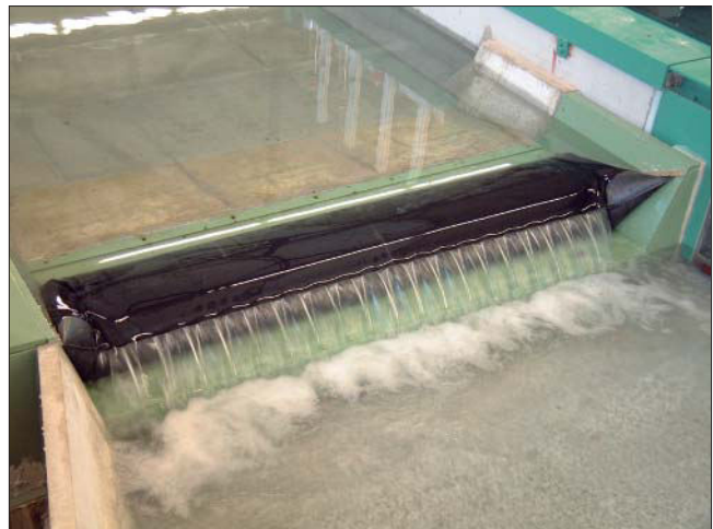
Bild 19: Wassergefülltes Modellschlauchwehr bei Überströmung, M 1 : 12,5
