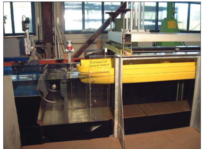
Bild 8: Blick auf das Oberhaupt der neuen Schleuse Bolzum mit Drucksegmenttor, zwei Störkörperreihen an der Sohle und abschließender Gitterwand (Energieumwandlungsanlage)
