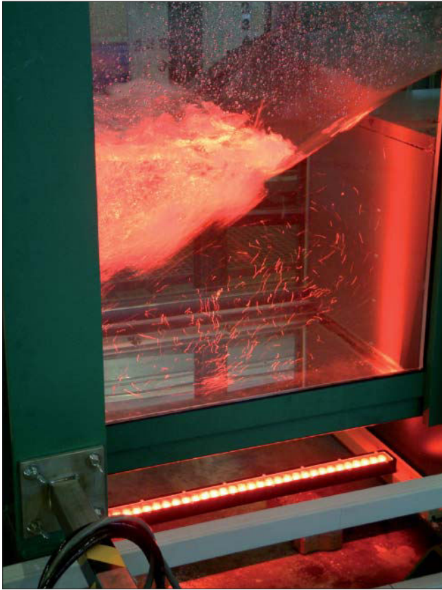
Bild 17: 0,80-m-Rinne mit überströmtem Absturz, LED-Lichtleiste (unten), Blick von der Seite
