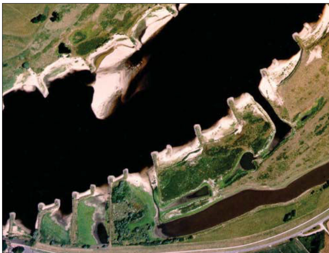
Bild 1 : Wandernde Sandbank in der buhngeregelten Elbe bei Hitzacker (El-km 519)
