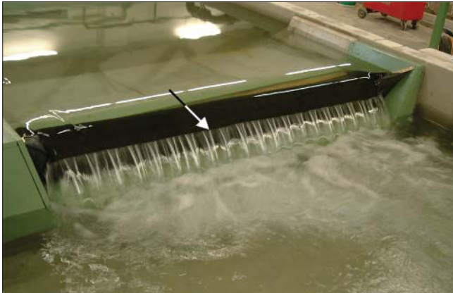
Bild 11: Foto des Schlauchwehrs (vor Einbau der Messtechnik)
