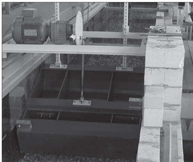
Bild 5: Versuchgerinne mit Wellengenerator
