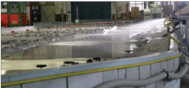
Bild 12: Beregnen des Modells während des Füllvorganges
