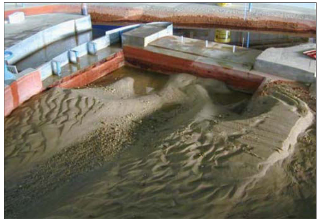
Bild 1: Kolkprozess im Unterwasser der Wehranlage Döhrener Wölle, Hannover, physikalisches Modell mit beweglicher Sohle, LWI, 2002
