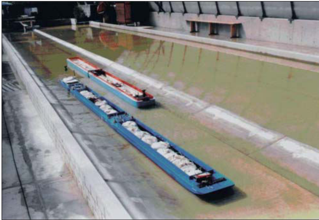
Bild 5: Begegnungsfahrt zweier Schubverbände im Standard-Trapez-Profil
