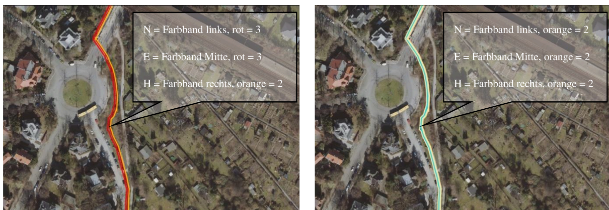
Abbildung 2: Kaitzbach im Bereich Gustav-Adolph-Platz: Bewertung des Istzustandes H = 2 befriedigend, N = 3 schlecht, E = 3 schlecht (links) und des Sollzustandes H = 2 befriedigend, N = 2 befriedigend, E = 2 befriedigend (rechts) der Gewässerentwicklungsfunktionen ( Umweltamt, 2006 )
