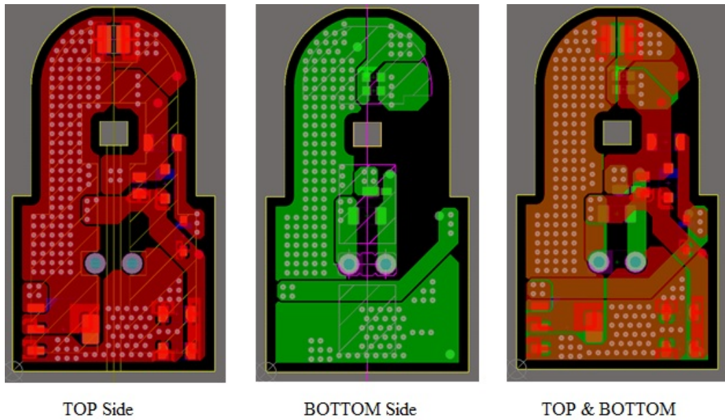
Fig. 14. Trazado de pistas de la PCB.
