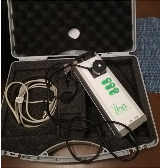
Kuva 22. Mittauksissa käytetty IBA Dosimetry Lxcan-luminanssimittari.
