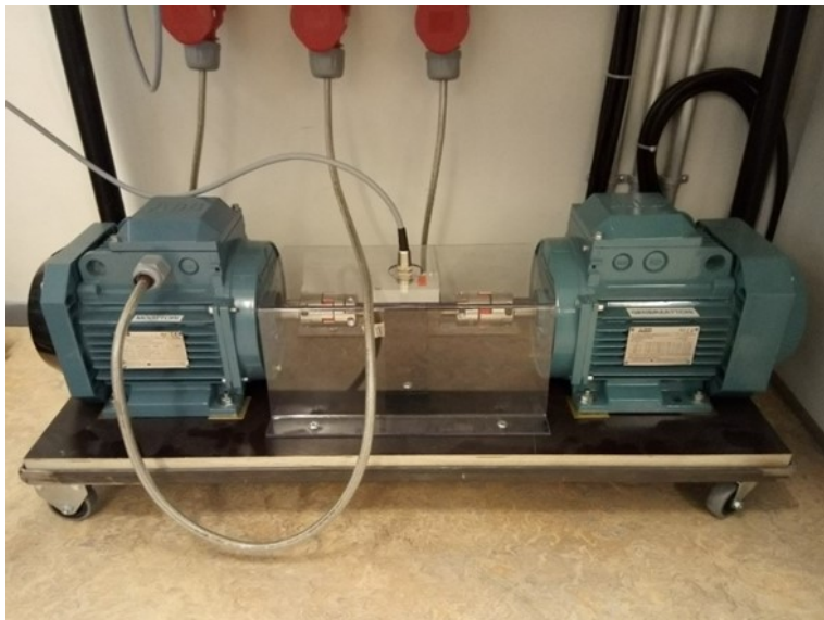
Kuvio 13. Momentti- ja pyörimisnopeusanturi T20WN asennettuna moottorin ja kuormamoottorin väliselle akselille
