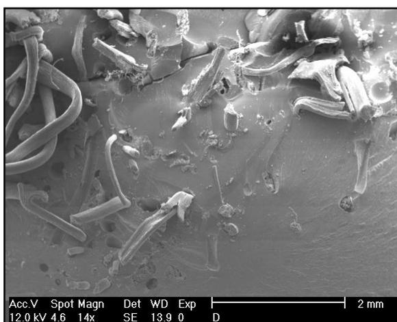
Gambar 6. Mekanisme Pull-out pada Specimen Bending
