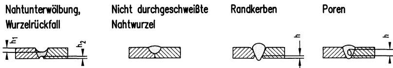
Bild 4.1 Imperfektionen, die den tragenden Schweißnahtquerschnitt mindern, an einer I-Naht-Verbindung am Stumpfstoß nach DIN 8563 T11
