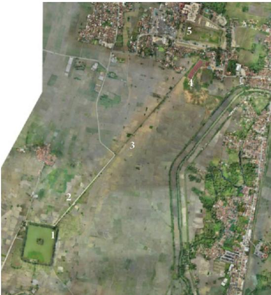
**Gambar 20.** Foto Udara Lingkungan Danau Tasik Ardi dan Sistem Filter Air ke Keraton Surosowan: (1) Danau Tasik Ardi; (2) Pangindelan Abang; (3) Pangindelan Putih; (4) Pangindelan Emas; (5) Keraton Surosowan (Fotografer: M. Oksy Rahim)
