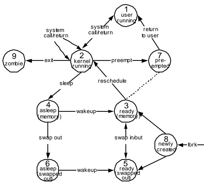
Gambarajah peralihan keadaan di atas melambangkan model proses Unix.
