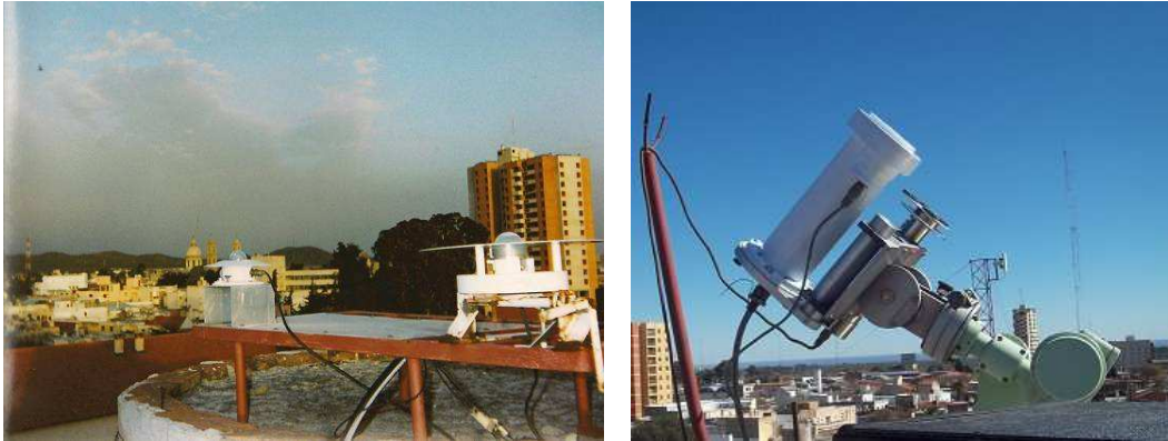
Figura 1. Vista de los sensores utilizados (piranómetros, izquierda, y pirheliómetro de incidencia normal, derecha) y su ubicación sobre el techo del Laboratorio de Energía Solar en la ciudad de San Luis.
