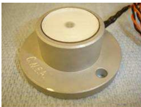
Figura 2. Radiómetro PAR desarrollado en el Grupo Energía Solar de la CNEA
