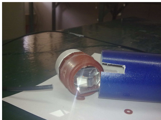
Figura 5: Detalle del montaje de los espejos.
