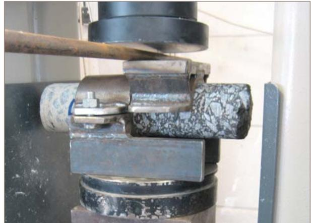
bilidad de los ensayos y a las variaciones de velocidad de carga, se destaca que el valor mínimo de resistencia residual fue 0,9 MPa y este hecho se produjo solamente en dos ocasiones. En el ensayo de flexotracción según ASTM C1609 las roturas no siempre se producen en el tercio central, en los ensayos de control se empleó un equipo con rigidez insuficiente para vigas de 150 mm de altura.
