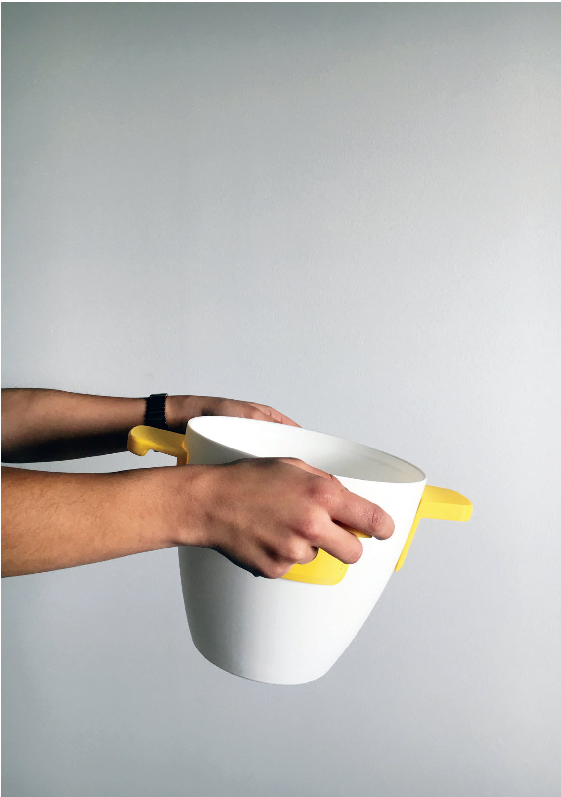
figura 103 Testes ergonómicos das pegas impressas
