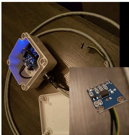
Figura 4-3 - Equipamento montado para medição de vibrações
