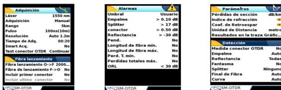
**Figura 5.** Parámetros de configuración OTDR T-BERD/ MTS-2000
