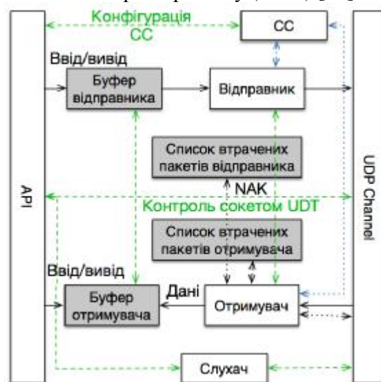
Рис. 4. Функціональна структура протоколу UDT
