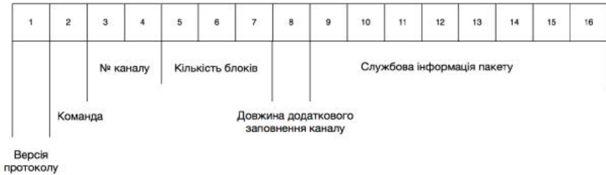
Рис. 5. Структура заголовку пакету даних протоколу
