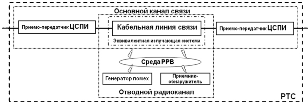
Рис. 5. Структура фрагмента радиотехнической системы
