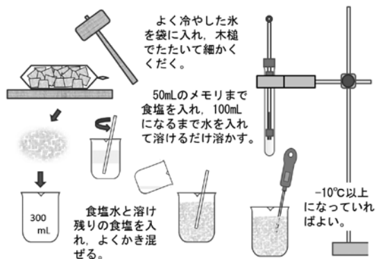
図9 試験管を冷やす氷と食塩水の準備
