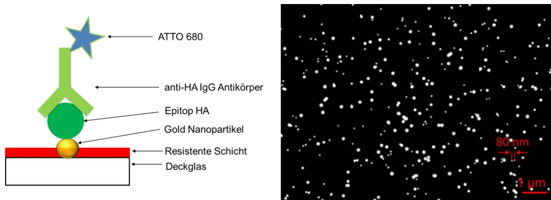
Abb. 148: Aufbau der Probe ( links ): Es wurde ein HA Epitop an die Goldnanopartikel adsorbiert und an diesen ein anti-HA IgG Antikörper, der mit dem Farbstoff ATTO680 markiert war gebunden. Der Partikelabstand ist 70 nm und Partikeldurchmesser 20 nm. Die Partikelzwischenräume wurden passiviert. Die Lokalisationsaufnahme ( rechts ) zeigt die lateralen Positionen der mit Farbstoffmolekülen markierten Antikörper.
