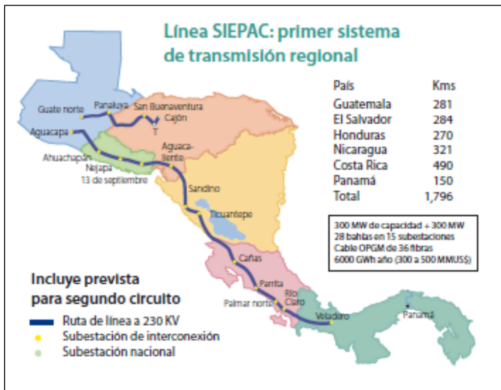
Abbildung 17: Regionales Elektrizitätsübertragungsnetz SIEPAC
