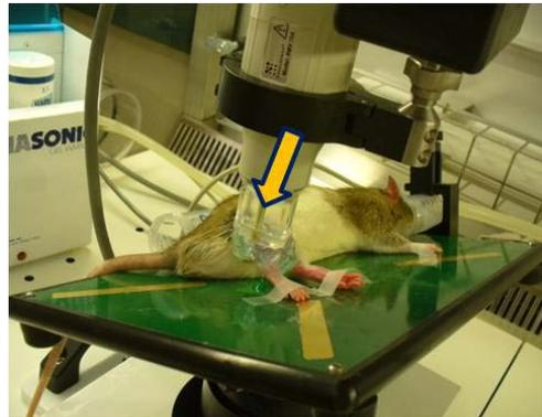
**Abb. 5: Positionierung des Tieres während der Ultraschalluntersuchungen.** Das Tier wird unter Narkose auf einer Heizplatte befestigt und der robotergesteuerte Ultraschallkopf (gelber Pfeil) kann das gesamte Tumolvolumen abtasten.
