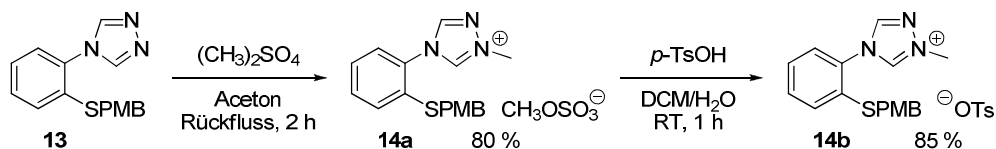
Schema 43: Synthese des 1-Methyl-1,2,4-triazoliumsalzes 14a durch Methylierung mit Dimethylsulfat gefolgt von dessen Überführung in das Tosylat 14b .
