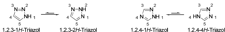
Abbildung 1: N-H-Tautomere des 1,2,3-Triazols und des 1,2,4-Triazols.
