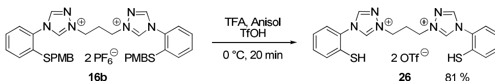
Schema 54: Entschützung der Thiolgruppe des symmetrischen Propylen-verbrückten Bistriazoliumsalzes 16b unter stark sauren Bedingungen.
