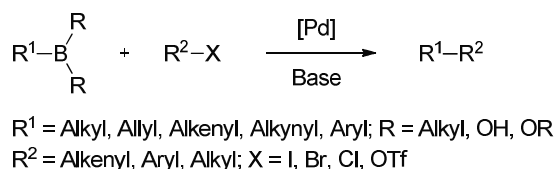
Schema 84: Palladium-katalysierte Kreuzkupplung nach Suzuki. 198
