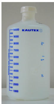
Abb. 3.13: Für die ^{23}\text{Na} - und ^{35}\text{Cl} -MR-Experimente wurde anstelle des Gelphantomes eine zylindrische Kunststoffflasche mit Durchmesser 20,7 cm als Messobjekt verwendet, die mit etwa 10l wässriger NaCl-Lösung (0,9%) befüllt war.
