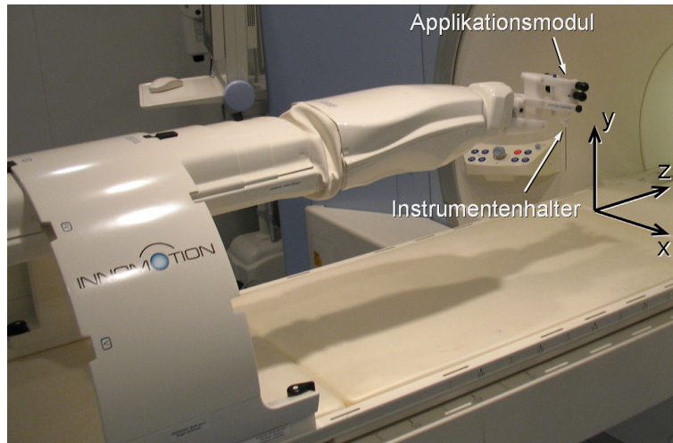
Abb. 3.1: Das für die Arbeit verwendete robotische Assistenzsystem InnoMotion™ montiert auf dem Patiententisch eines klinischen 1,5 T Ganzkörper-MR-Tomographen (MAGNETOM Symphony, Siemens AG, Healthcare Sector, Erlangen, Deutschland). Das Applikationsmodul mit austauschbarem Nadelhalter sowie das Koordinatensystem des MR-Tomographen sind gekennzeichnet.
