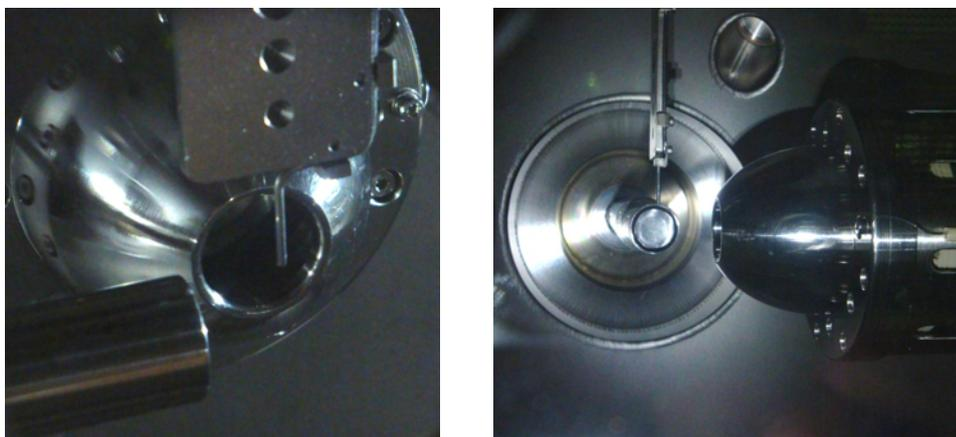
**Abbildung 3.17:** Fotos der Reaktionszone. Man sieht den mit mehreren Lochblenden versehenen Targethalter mit der daran befestigten Gaskapillaren von oben kommen. Der Ionenstrahl tritt durch die Öffnung der Abbremslinse. Die emittierte Röntgenstrahlung wird durch den Röntgendetektor nachgewiesen. links: Sicht aus Richtung des PSDs. rechts: Sicht aus Richtung des Flugzeitspektrometers.
