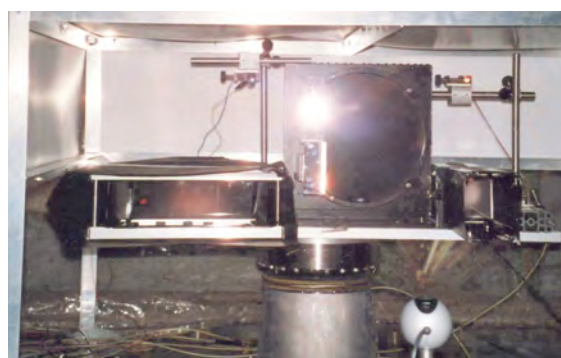
Abbildung 84 Ansicht der Laserjustage. Links und rechts neben dem Feldspiegel sind die Laserdioden und Kameras mit Bildschirmen angebracht. Zur Überwachung des rechten Rückspiegels wird ein größerer Schirm benötigt als für den linken, da dieser geschwenkt wird um mehrere Lichtwege anzufahren.
