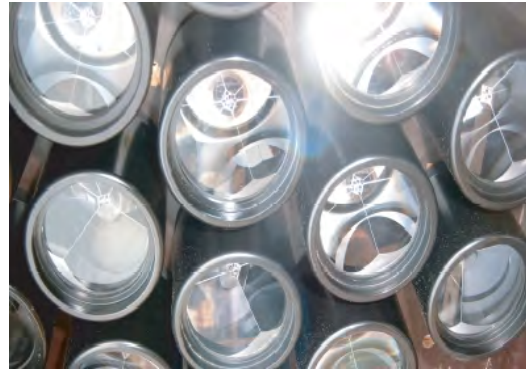
Abbildung 88 Feld aus Retroreflektoren (Foto von Tschritter 2007)
