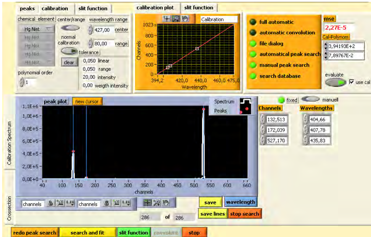
Abbildung 310 Mit LabDOAS Calibration lässt sich automatisch die Kalibrierung des Spektrographens anhand dem Spektrum einer Spektrallampe und einer Datenbank mit Spektrallinien bestimmen.
