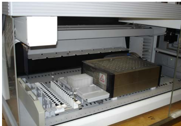
Abbildung 45: Pipettierroboter Genesis Workstation 150 der Firma Tecan
