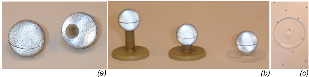
Abbildung 2.2: Passive Marker mit retroreflexiver Oberfläche und Vertiefung zur Befestigung (a) sowie passende Halterungen (b), mit denen sich die Marker fixieren lassen. In (b) sind linksseitig die bislang benutzten Halterungen mit aufgesteckten Markerkugeln abgebildet; rechtsseitig ist eine hier verwendeten Halterungen aus Plexiglas® zu sehen, die den Blick auf den Untergrund zum Zweck einer exakten Positionierung freigibt (c).
