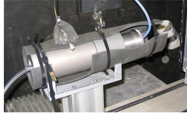
Gleichmäßige konstante Durchflussmengen können mit zwei elektrisch angetriebenen Kolben erzeugt werden, deren Ausstoß wechselnd durch ein Ventil geleitet wird. Während der eine Kolben Flüssigkeit ausstößt, saugt der andere neue aus einem Reservoir an. Die Durchflussmenge lässt sich einstellen.
