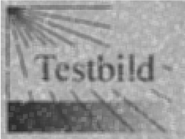
Abb. 3.7. Testbild unter Mittelwert-Filter
