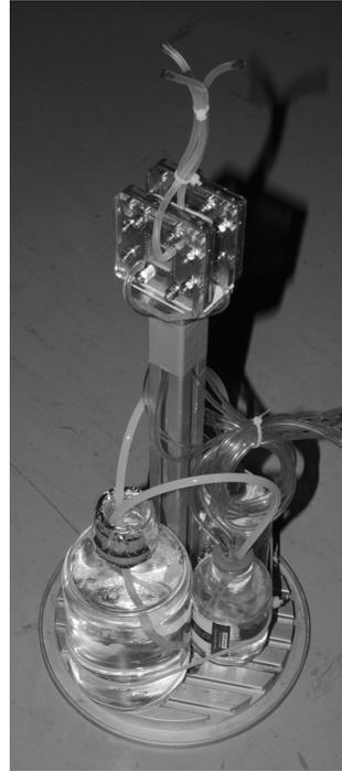
Die beiden Brennstoffzellen sind elektrisch in Serie geschaltet, damit sichergestellt ist, daß durch beide stets der gleiche Strom fließt. Die Brennstoffzellen können zur Elektrolyse an eine Laborstromquelle mit Spannungs- und Strombegrenzung angeschlossen werden, oder über einen Widerstand Leistung erbringen, siehe das Schaltbild in der nebenstehenden Abbildung.
