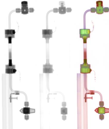
**Abb. 1.16.** Neutronen-Radiographie, Gamma-Radiographie und eine aus beiden Bildern kombinierte Falschfarben-Darstellung
