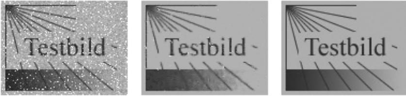
**Abb. 1.8.** Korrektur von Rauschen und Strahlungsuntergrund (links) durch digitale Bildfilter (mitte) und auf Zeitreihen basierenden Schätzverfahren (rechts)
