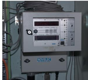
Der Strahlungsmesser ist in der Kasematte unterhalb des Strahlrohres an der Wand befestigt. Seine Anzeige außerhalb der Kasematte dient auch vor dem Betreten der Kasematte einer ersten Orientierung über das herrschende Strahlungsniveau. Für längere Arbeiten sollte dieses nicht über  $1 \mu\text{Gy h}^{-1}$  liegen.
