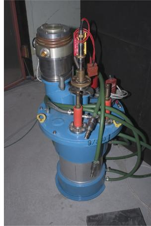
Das Vorexperiment zur Visualisierung von Zweiphasen-Flüssen einer  $^3\text{He}$ - $^4\text{He}$ -Mischung (vgl. Abs. 9.5) wurde mit einem Helium-Kryostat durchgeführt, der Temperaturen bis  $1,5\text{ K}$  erreicht.
