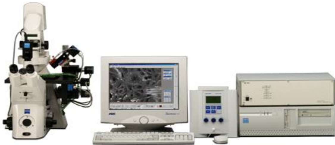
Abbildung 6.1: Das Mikroskop mit dem entsprechenden Mikroinjektionsaufsatz ist links zu sehen. In der Mitte und Rechts sind der PC mit der AIS2-Software, der Femtojet und die Kontrolleinheiten für die Motoren abgebildet. (Quelle [62])
