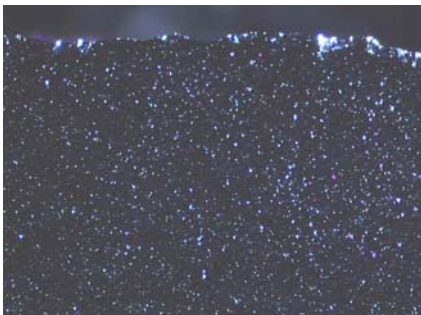
Abb. 4.5.2: Die Oberfläche der Trägerplatte (Kontaktseite zum Chip), auf die die Partikel abgelagert werden.
