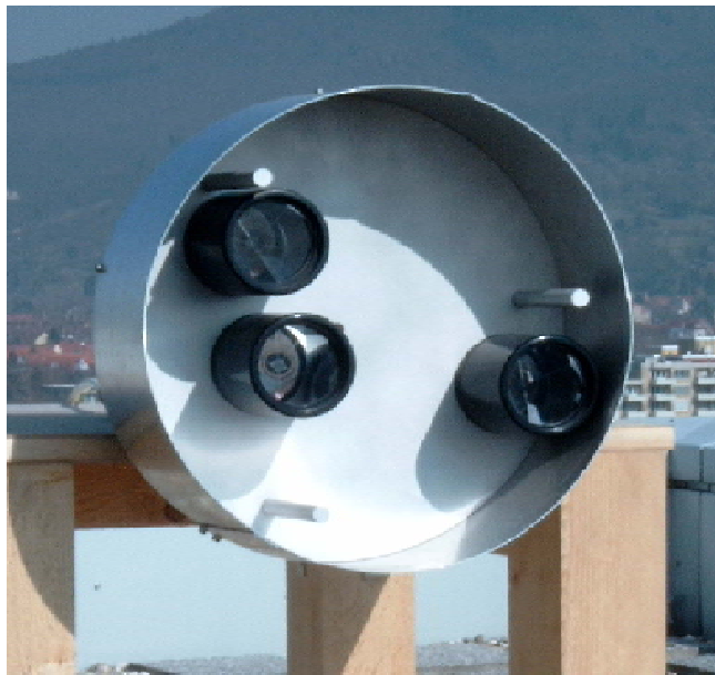
Abbildung 6.30: Bild des drehbaren Kurzschluss-Retroreflektorfeldes. Durch die gezeigte Anordnung der Retroreflektoren wird eine komplette Abdeckung des Strahlquerschnitts erreicht. Dies ist wichtig, da bei schräger Emission eines Lichtstrahls die Positionen der Schatten von Ein- und Auskoppelspiegel innerhalb des Strahlquerschnitts abhängig vom Emissionswinkel sind.
