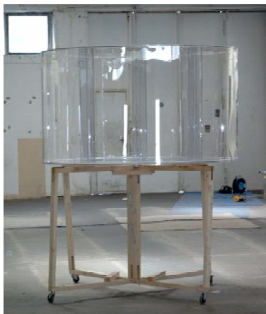
Abbildung 7.3: Bild eines der Behälter aus Polycarbonat, welche bei der Testmessung in der Fabrikhalle zur Simulation von \text{NO}_2 -Konzentrationsverteilungen verwendet wurden. Der Behälter hat einen Durchmesser von 2 m und eine Höhe von 1 m.
