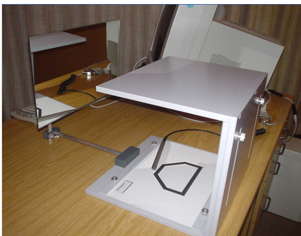
Abbildung 8.1.: Versuchsaufbau der Spiegelzeichnen-Aufgabe (links). Verschiedene Figuren, wie sie beispielsweise rechts dargestellt ist, mussten nachgezeichnet werden.
