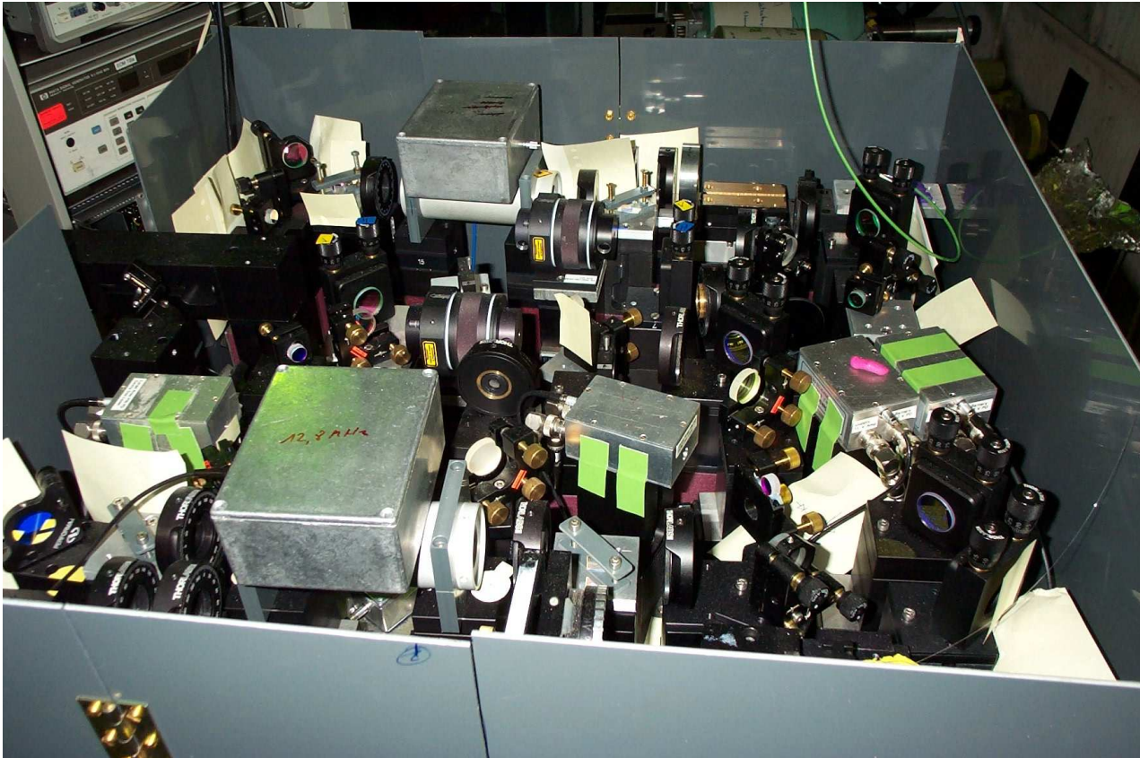
Abb. 4.12: Optischer Aufbau zur Pound-Drever-Hall-Stabilisierung von Resonator und Farbstofflaser.
