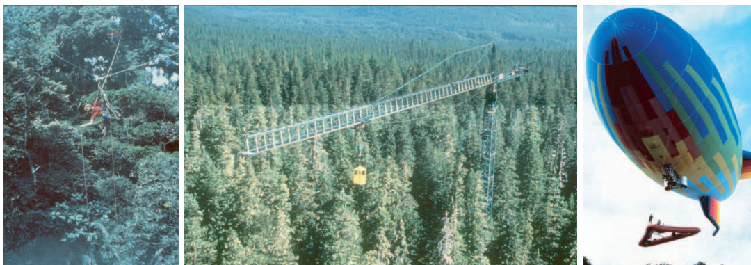
Abbildung 5.7: Zugang zu Kronendächern: ( links ) Besteigung eines Baumes mit Einseiltechnik. ( mitte ) Kronendachzugang mit Kran. ( rechts ) Absetzen einer Messplattform per Ballon.
