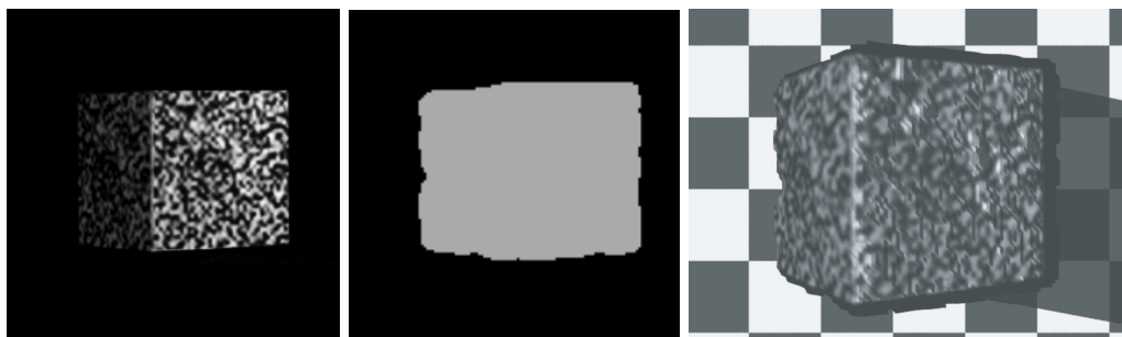
Abbildung 7.4: Würfelsequenz: ( links ) Originalbild des Würfels. ( mitte ) Bild des Ranges, in dem grauen Bereich war die Rekonstruktion erfolgreich. ( rechts ) Rekonstruierte 3D-Oberfläche mit projiziertem Originalbild.
