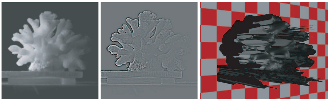
Abbildung 8.9: Koralle: Originalbild, hochpassgefiltertes Bild und 3D-Darstellung der rekonstruierten Oberfläche. Aufgrund der starken Tiefenunterschiede ist die Qualität der Rekonstruktion schlecht. Die Koralle ist etwa 5 cm hoch.
