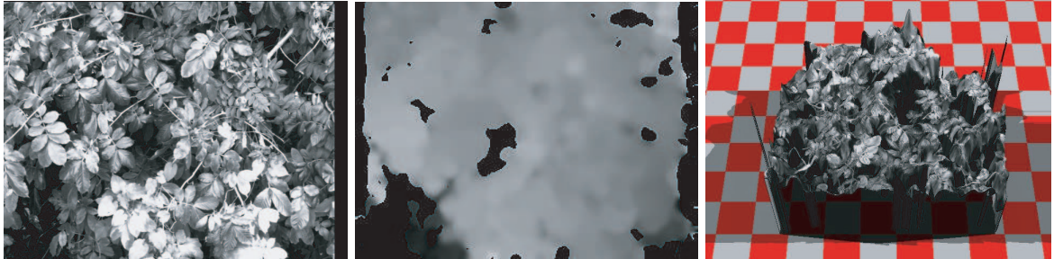
Abbildung 8.8: Inga sapinoides : Originalbild, Tiefenbild und eine 3D-Rekonstruktion der rekonstruierten Oberfläche. Der Bildausschnitt zeigt einen etwa 1,5 \times 2 Meter großen Bereich, die Entfernung beträgt etwa 8 Meter.
