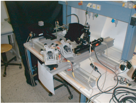
Abbildung B.1: Ground Truth Sequenzen: ( links ) Das Aufnahmesystem. Die Diodenarrays links der Kamera dienen zur Beleuchtung. ( rechts ) Skizze des Aufnahmesystems. Die Kamera ist auf ein System von zwei Verschiebetischen montiert, der Würfel auf ein System von zwei Verschiebetischen und einem Drehtisch.
