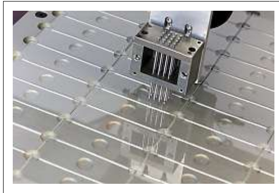
Abb.1.3: Ein Microarray-Roboter beim Auftragen der Sonde. Der Ausschnitt zeigt den Kopf mit den Nadeln („pins“) die gelöste DNA-Sonden in einem Flüssigkeitsreservoir enthalten und durch Kontakt mit der Oberfläche auf die Glasobjekträger auftragen („spotting“).
